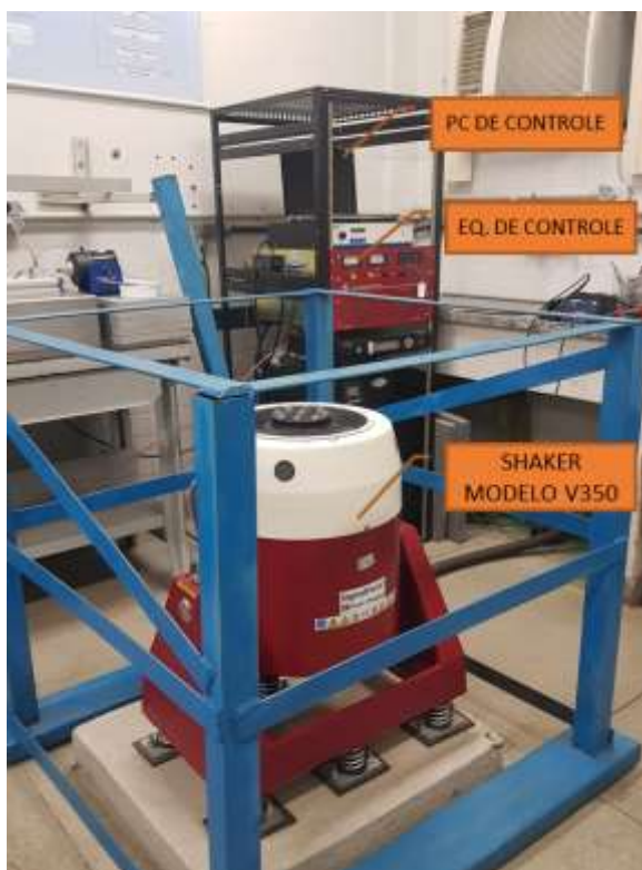
Figura 33 - Shaker modelo V350 e o sistema de controle de vibrações.
